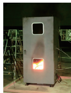
図4 18kWh相当の蓄電池設備の延焼状況
