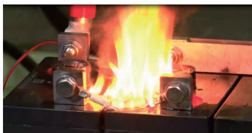
図3 大電流による発火状況
